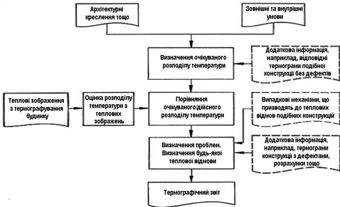
Рисунок 1 – Загальна процедура оцінки теплових зображень при тепловізійних обстеженнях
